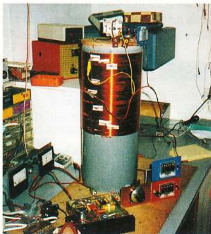
200 windingen op een stuk rioolbuis (diameter 20 cm) vormen de antennetuner.
